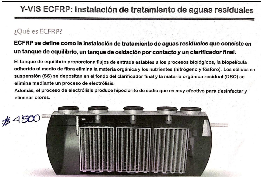
Figura 2. Prototipo de planta de tratamiento de aguas residuales a pequeña escala.
